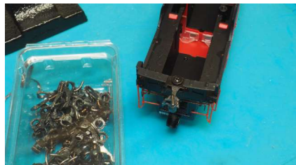
Die Lok hat zum Abschluss des Umbaus Kupplungen von Kadee bekommen.
